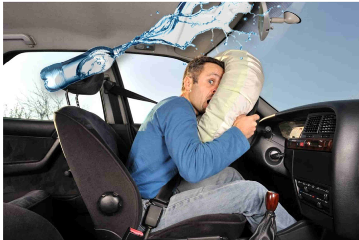
Joonis 29. 0,51 lahtine veepudel lendab äkkpidurduse korral autos edasi endisel kiirusel.
