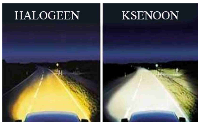
Joonis 43. Võrdlus halogeen- ja ksenoonvalgustitest [29].
